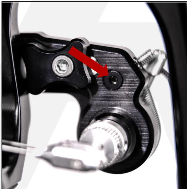
Dévissez pour éloigner le contact entre la vis de réglage et la butée haute qui la rejoint lorsque la drisse est en tension. Le réglage couvre une large plage de hauteur selon la marque de votre arc.
