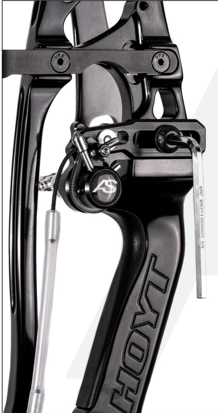
Commencez par fixer le MONOREST à l'arc en utilisant la vis 5/16" et sa rondelle crantée à l'aide de la clé fournie. Le serrage doit être ferme pour maintenir le repose-flèche dans sa position.
