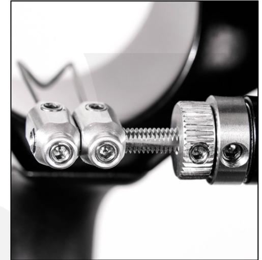
Sauf pour réaliser un essai rapide ou dans certaines configurations particulières, n'intervenez pas sur l'épingle elle-même, et placez-la à l'extrémité du porte-épingle.
